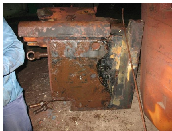
б) «разбивание» и выкрашивание наделок подушек рабочих валков
