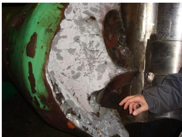
а) разрушение шпинделя привода рабочих валков по головке (шарнир Гука)
