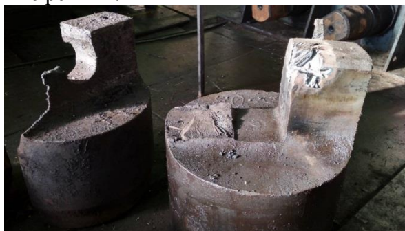
б) разрушение лопасти хвостовика валковой муфты от изгиба и сдвига
