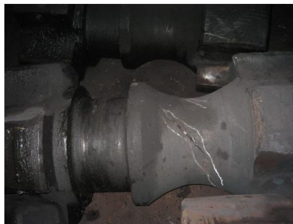
Рисунок 4. Брехшпиндель пильгерстана 6÷12" (усталостная трещина, косой излом)
